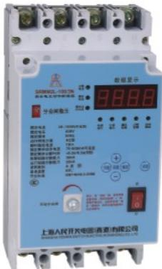
SRMM2L系列剩余电流动作断路器（简称智能断路器）是本公司新研制开发的产品，是一种一体式、多功能、智能型、主电路电流可设定的智能断路器。适用于配电变压器低压侧三相四线中性点直接接地(TT)的低压电网，用来对人身触电危险提供间接接触保护，也可对线路或用电设备的接地故障、过电流、短路等进行保护。
